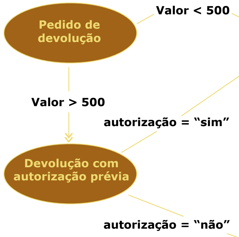
Figura 3: Notação de máquina de estados para modelagem compartilhada entre as equipes técnica e de negócios.
